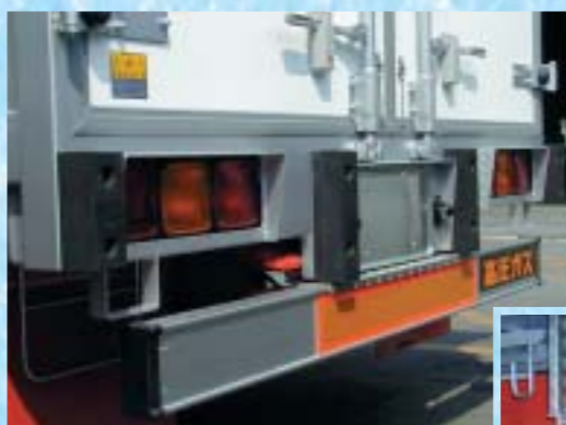
オプション架装例 写真左 ステンレス仕様:リヤドア外板、ハンドルキャチ、ドアヒンジ、ハンマーロック その他の仕様:ステップ式バンパー、リヤ看板、ルーフ操作スイッチ、テールランプ 写真中 ホーム当りゴム中央延長型:ナンバー中央取付(カバー&ライセンススランプ×2) リヤドア外板白色カラーアルミ、左右足掛けステップ 写真右 一体式泥除け。他に三分割式もあります。
