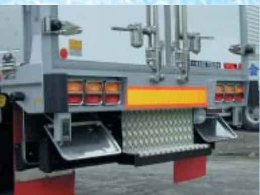
オプション架装例 写真左 ステンレス仕様:リヤドア外板、ハンドルキャチ、ドアヒンジ、ハンマーロック その他の仕様:ステップ式バンパー、リヤ看板、ルーフ操作スイッチ、テールランプ 写真中 ホーム当りゴム中央延長型:ナンバー中央取付(カバー&ライセンススランプ×2) リヤドア外板白色カラーアルミ、左右足掛けステップ 写真右 一体式泥除け。他に三分割式もあります。
